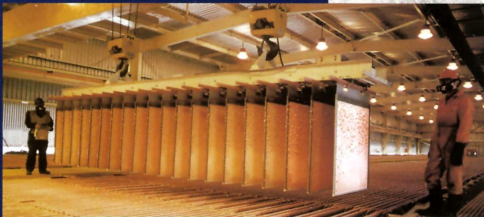
Planta de producción de cátodos de cobre con una pureza de 99.99%
